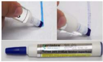
Plumas Printexpen sustratos no absorbentes para medir tension superficial
